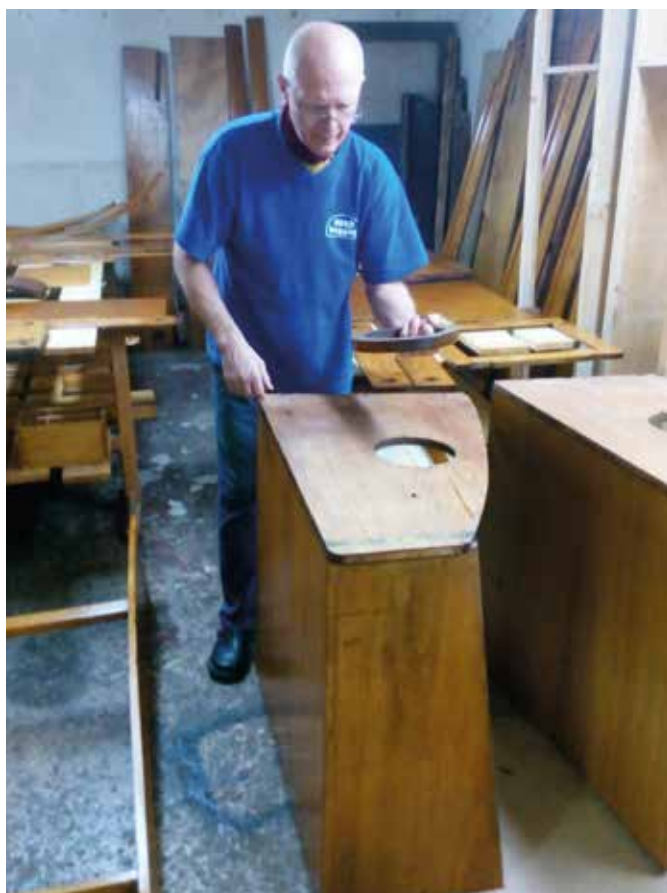
Josef Filip v průběhu renovace obložení benzínových nádrží umístěných na obou řídicích stanovištích
