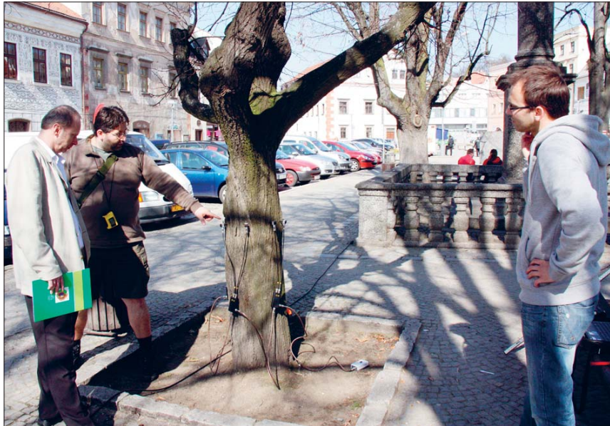
Jan Štěpánek (vpravo) měřil lipu č. 3 akustickým tomografem. Luděk Praus výsledky vyhodnotil. Vlevo Jiří Zachar, vedoucí velkomeziřického odboru životního prostředí.
